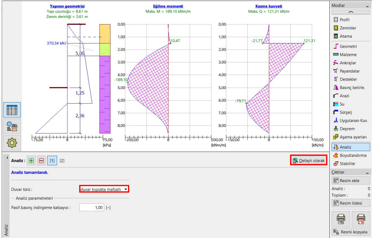
“Analiz” Penceresi – 1. Aşama (duvar topukta mafsallı)
